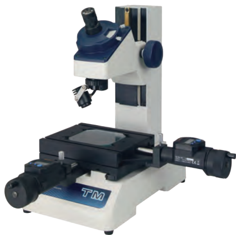
Микроскоп TM-505B, снабженный опциональными цифровыми микрометрическими головками
