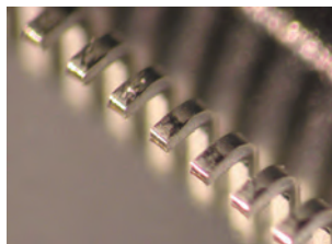
Пример измерения : высота пиков на QFP-корпусе
