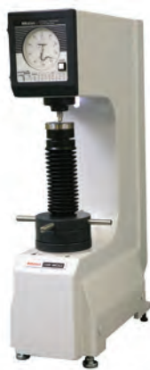
HR-210MR Твердомер по Роквеллу Ручное изменение веса (с выбором общей испытательной нагрузки) и управление предварительной нагрузкой. Моторизованный привод контролирует последовательность нагружения.
