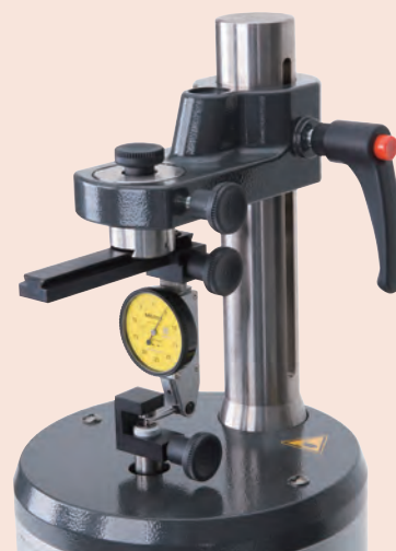
Калибровка рычажно-зубчатых индикаторов с дополнительными принадлежностями
