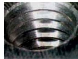
Метчик с покрытием DLC в АК7ч
