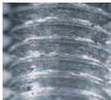
Заусенцы на поверхности резьбы из-за недостаточного количества СОЖ. Способы устранения: канавки для СОЖ
