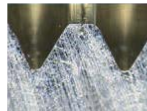
Профиль резьбы с использованием специального раскатника
