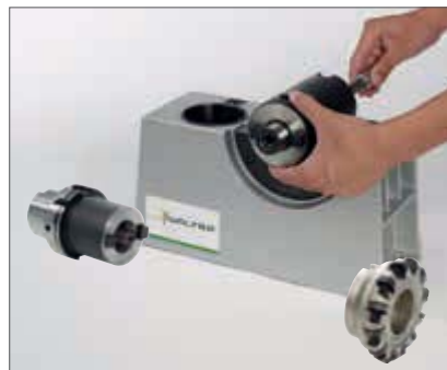
6. Вручную свинтить вместе удлинитель и адаптер для фрез, используя ключ.
