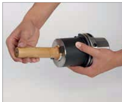
3. Очистить внутреннюю поверхность конуса и опорную поверхность
