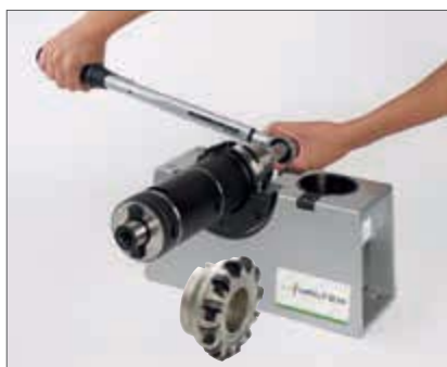
10. Затянуть динамометрическим ключом.
