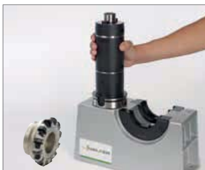
11. Установить собранный базовый держатель в коническую втулку.
