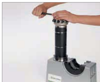
12. Установить и закрепить инструмент.
